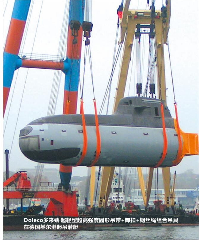
Doleco多来劲·超轻型超高强度圆形吊带+卸扣+钢丝绳组合吊具
