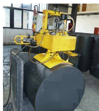
圆弧形真空吸盘吊具(额定载荷1000kg)
