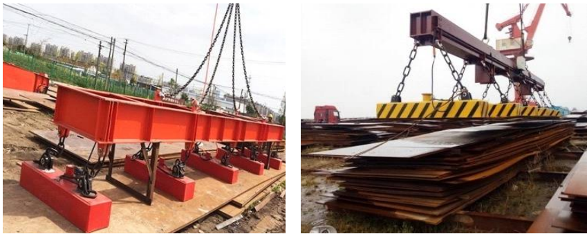
钢板电磁铁组合吊具(搬运单张钢板)
