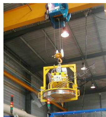
卷材真空吸盘吊具(额定载荷2000kg)
